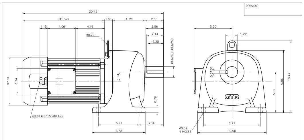
NOTE: THE BRAKE LEADS ARE PULLED INTO THE TERMINAL BOX.
