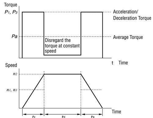
$$P_a = \sqrt[3]{\frac{(P_t^3 \times n_1 \times t_1) + (P_s^3 \times n_3 \times t_3)}{(n_1 \times t_1) + (n_2 \times t_2) + (n_3 \times t_3)}}$$
