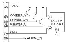
AC電源、モーター部の接続は、シンクロジックと同じです。
