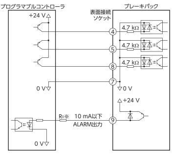
※ 電流制限抵抗 Ro を接続する場合の推奨抵抗値  $2.7 k\Omega \sim 4.7 k\Omega (1 W)$
