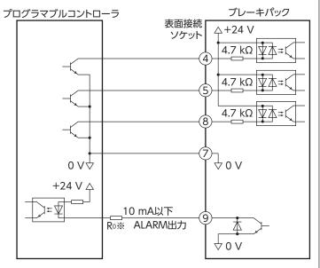
※ 電流制限抵抗 Ro を接続する場合の推奨抵抗値  $2.7 \text{ k}\Omega \sim 4.7 \text{ k}\Omega (1 \text{ W})$
